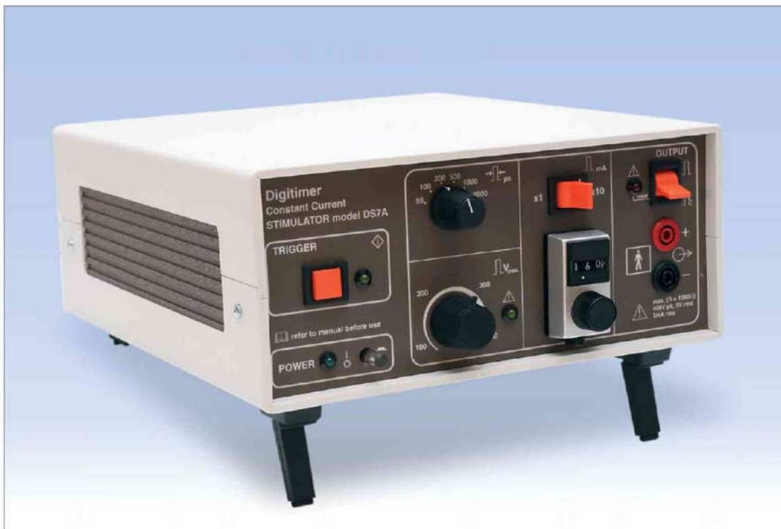
Digitimer 高電圧刺激装置モデル DS7A は、神経及び筋組織の電気活動の検査中に経皮刺激を得るために短時間の定電流高電圧パルスを呈示します。出力電流は、人病理事例の要求に合致するため 100 V 未満～400 V 連続可変ソース電圧から、0～100 mA の範囲に渡り連続的に可変です。短いパルス持続時間は、被験者への不快感を最小限に抑えるために利用可能とされています。当該パルス持続時間は、6 段階で 50  $\mu$ s～2 msec まで変更されることが可能です、そして、特別に設計された絶縁された出力部は、刺激アーティファクトを最小限に抑えながら矩形（電流）パルス形状を持続します。当該装置は、非導電性の自立式筐体内に組み込まれています、そして、交流電源より電源供給されます。より高い電圧を得るには、Digitimer 刺激装置 D185 をお勧めします。
