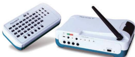
最大48チャンネル/最大サンプリング周波数8kHzの生体信号収録装置です。アクティブ電極を標準装備しており、幅広い測定環境に対応できます。Bluetooth®を内蔵しており、離れた場所からの計測条件設定及びリアルタイムモニタを可能にしています。
